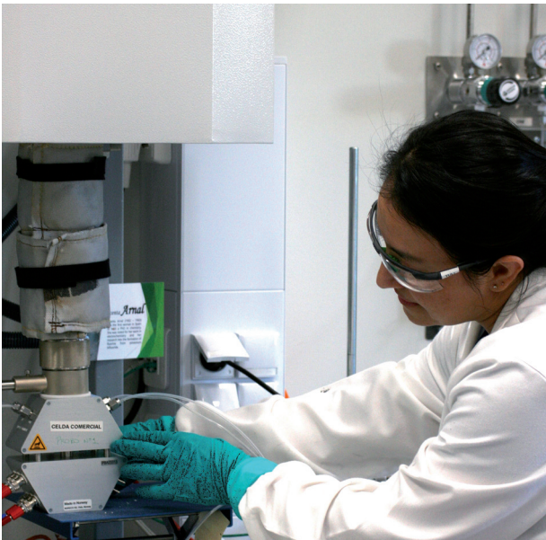
Preparación de equipos de testeo electroquímico para celdas SOEC en el laboratorio de CENER/ Preparation of electrochemical testing equipment for SOEC cells at the CENER laboratory
