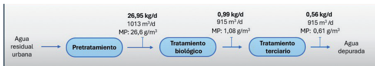
Fig. 2. Concentración original de MPs en los diferentes puntos de la línea de aguas (sin aplicación de la planta de Captoplastic) / Initial MP concentrations at the different points of the water line (before implementation of the Captoplastic plant).
