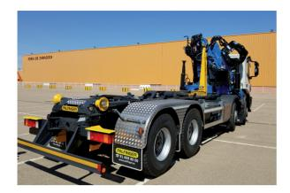
fácilmente en la cabina. Su ergonomía, simplifica la manipulación con una única palanca de mando tipo joystick, que desde la cabina controlará con precisión los movimientos de los contenedores mientras que la pantalla táctil, informará la posición del brazo. Ambos proporcionan información en tiempo real.
