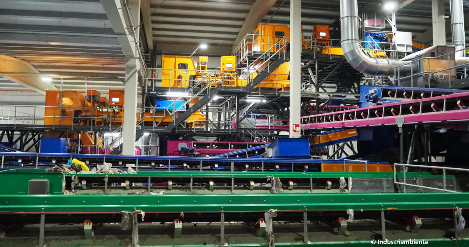
implantación como criterio básico de diseño, que sirve para garantizar la correcta dosificación al primer óptico de la cascada de rodantes. De hecho, sobre la primera cinta aceleradora se instala un repartidor de flujo para asegurar la distribución homogénea de los residuos a la entrada de la cascada de separadores, optimizándose así las capacidades de recuperación de materiales.
