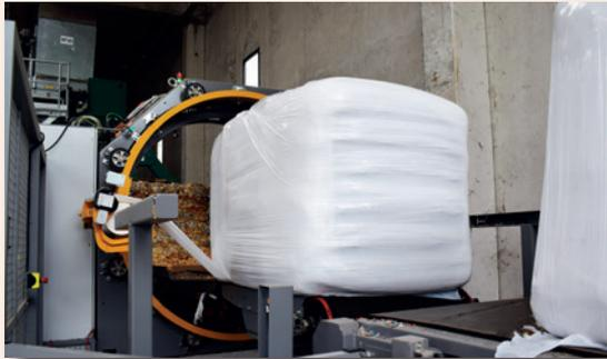
También contamos con la solución para abrir las balas de combustible e introducirlas en el proceso de producción de energía a partir de residuos. La abridora de balas CW 3600 de Cross Wrap abre automáticamente las balas, retirando la película de embalado y los alambres de las balas. Es una forma limpia y rentable de abrir las pacas. La eliminación eficaz de alambres y el film garantiza que estos materiales puedan reciclarse.
