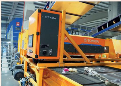
**Descripción del proceso:** Tras el proceso de biosecado de la fracción orgánica, el material llega a 2 AUTOSORT® en 2 líneas paralelas. Se seleccionan plásticos y CBA para ser enviados a la cadena de separadores ópticos de la fracción rodante.
