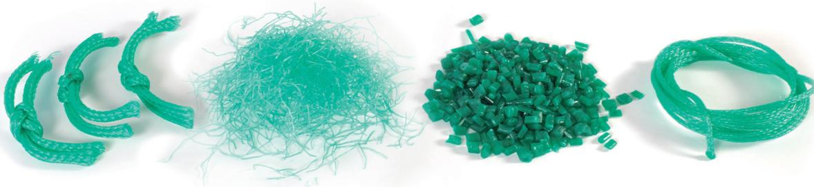
**Figura 1.** Pruebas concepto de reciclado mecánico por fusión de residuos de redes provenientes de empresas de la Comunidad Valenciana.
