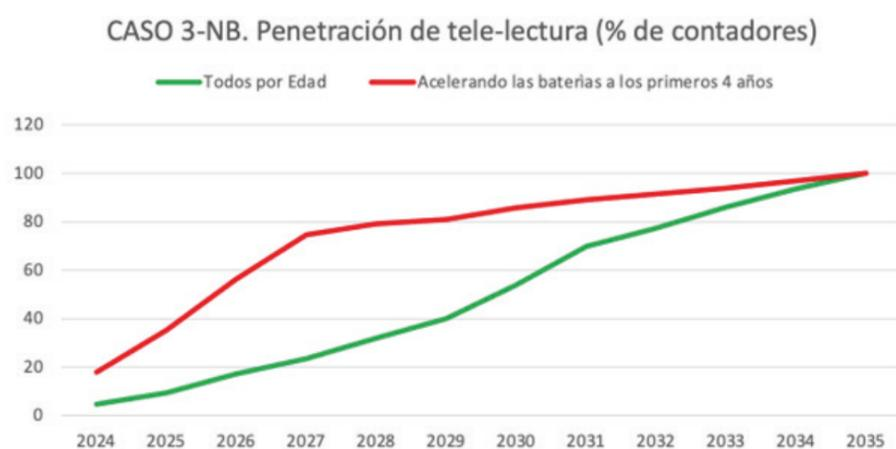
Figura 32. Grado de penetración de la tele-lectura (en porcentaje de contadores tele-medidos), para el CASO 3-NB, con dos tipos de implantación: “Todos por edad” y “Acelerando las baterías a los primeros cuatro años”.
