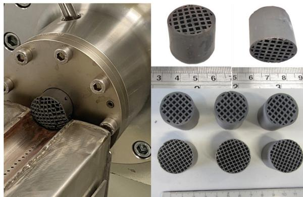
Figura 2. Extrusión de muestras tipo "honeycomb" a partir de  $\text{CaMnO}_3$  y una densidad celular de 44 y 90 cps
