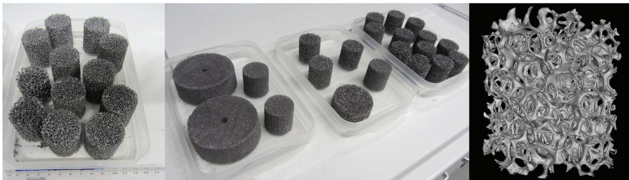
Figura 3. Muestras tipo espuma dopadas a partir de  $\text{CaMnO}_3$  y una tomografía computarizada de la muestra.
