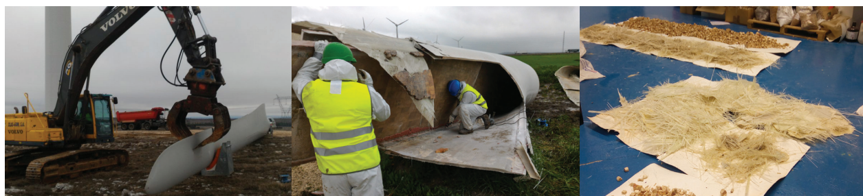
Imagen 3. Reciclado de palas de aerogenerador en proyecto REFIBRE. Fuente: CARTIF.
