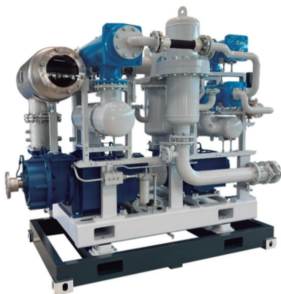
Compresor AERZEN serie 2C, exento de aceite, para biogás y CO_2 . Hasta 10 bar g, 166–2.600 m^3/h y 90–1.000 kW, con refrigeración por agua.
