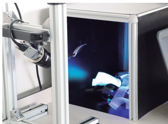
Imagen 2 - Sistema de detección e identificación de marcadores UV en polímeros
