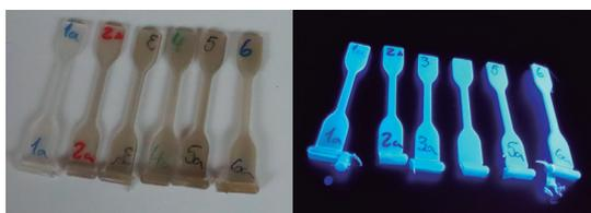
Imagen 6 – Simulación de reciclado con 6 ciclos de reprocesado. Remanencia del marcador en la muestra
