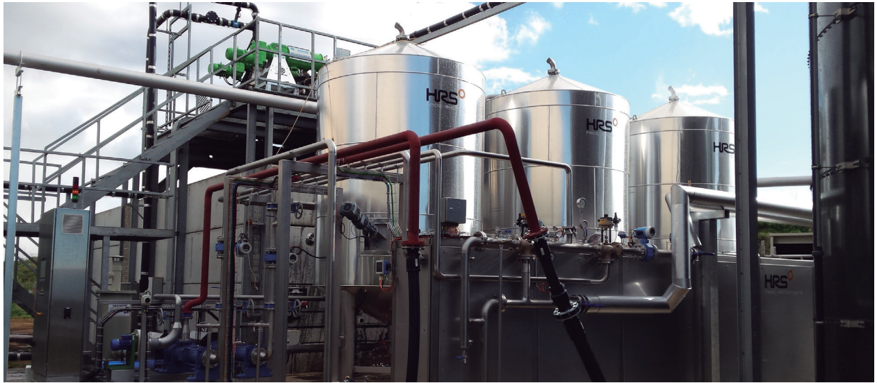
El Sistema de Pasteurización de Digestato HRS (DPS) genera un ahorro energético de hasta el 70% en comparación con otras tecnologías de tratamiento de digestato. A la izquierda, el HRS DCS instalado en una planta de biogás en España
