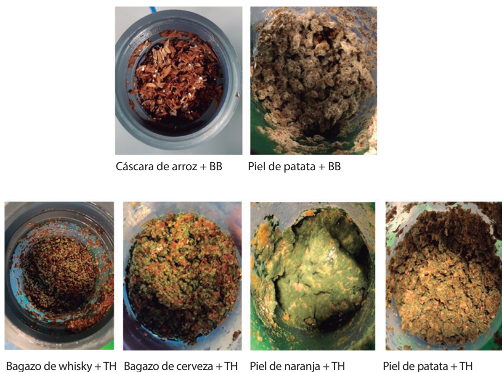
Figura 3. Sustratos con mayor concentración de esporas al final del proceso de FES con Beauveria bassiana (7 días de proceso) y con Trichoderma harzianum (5 días de proceso)
