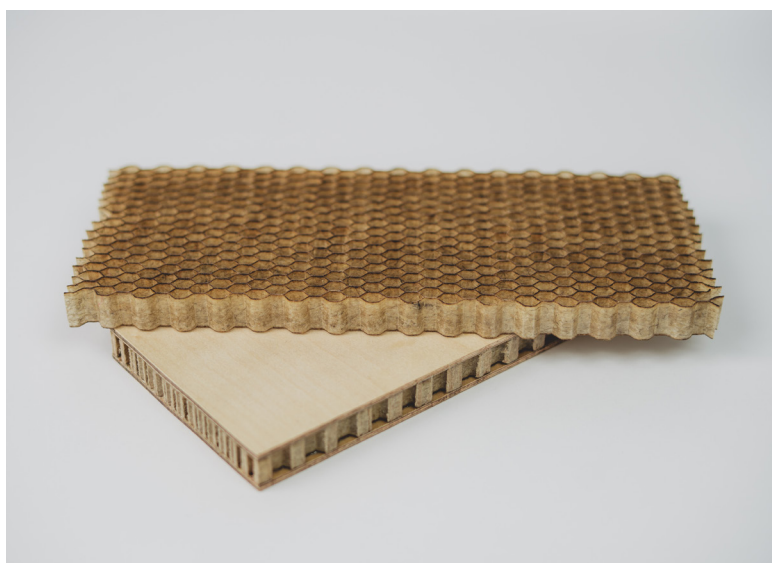
Ilustración 1. Estructura de fibras naturales on núcleo sostenible tipo honeycomb
