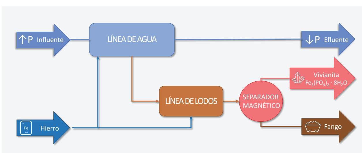
Esta tecnología posee la capacidad de recuperar hasta un 80% de la vivianita presente en los lodos, representando aproximadamente el 60-65% del fósforo total contenido en el flujo entrante a la depuradora, con un producto mineral de hasta un 80% en pureza y 98 mg P/g de vivianita.
